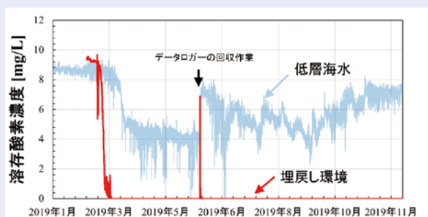
図5-2-7 埋め戻し環境下での溶存酸素量の変化
