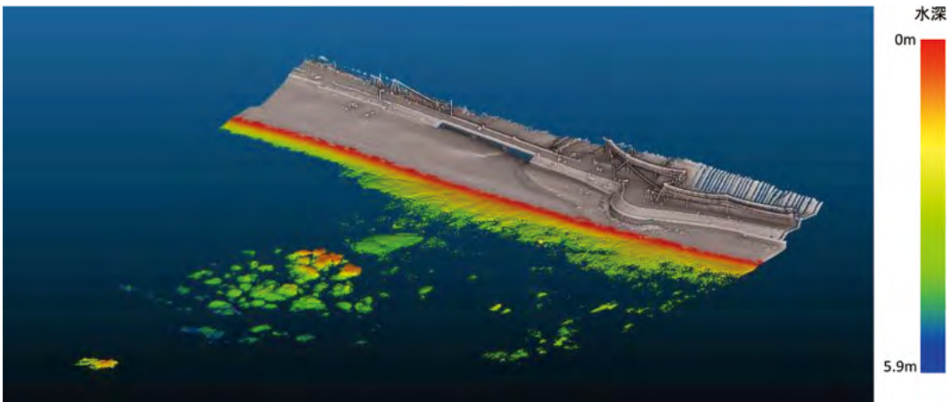
図 3-6-20 グリーンレーザーによる地形図の例 (上ノ国漁港遺跡)
