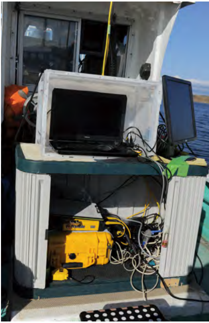
図 3-6-9 サイドスキャンソナー船上ユニット（送受信機）とコンピューター（上ノ国漁港遺跡）
