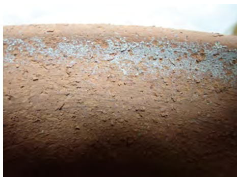
図 5-4-1 塩類の析出によって表面の剥離が進行している土器
