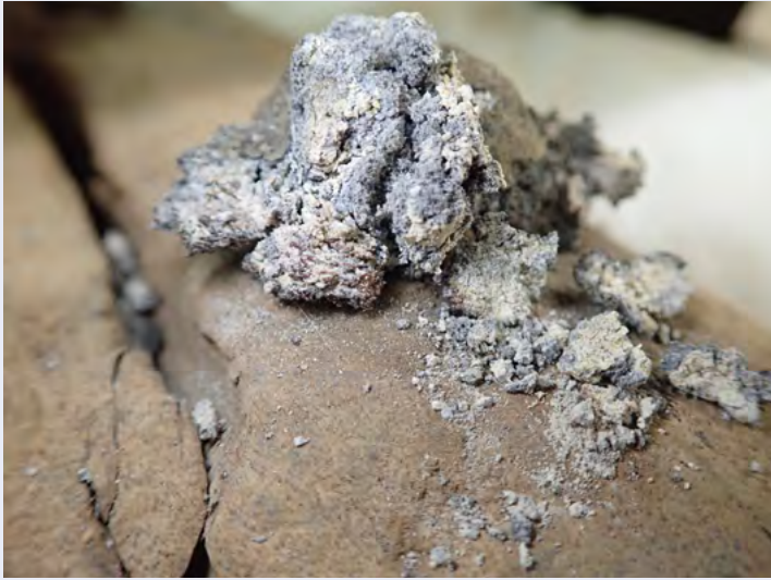
図 5-4-6 硫化物塩に由来する鉄製品の劣化
