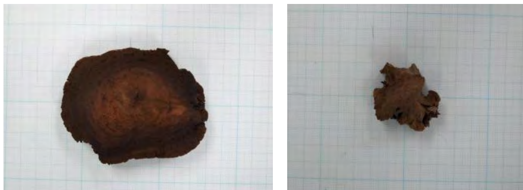
図5-3-14 水浸出土木材の不可逆的な収縮(風乾による円盤試料の収縮の様子) 左: 風乾前、右: 同一資料を風乾したもの
