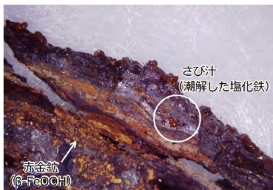
図 5-4-3 塩化鉄に由来する劣化（さび汁と赤金鉱）
