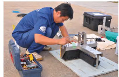
図 3-6-13 舷側固定式のマルチビーム測深機機装準備 (相島海底遺跡)
