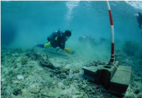
図 3-5-5 コンクリートブロックを用いた仮設基準点 (倉木崎海底遺跡)
