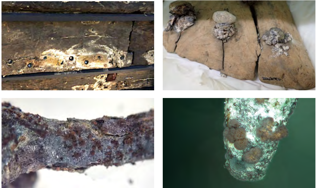
図 5-4-5 硫黄に起因する劣化
