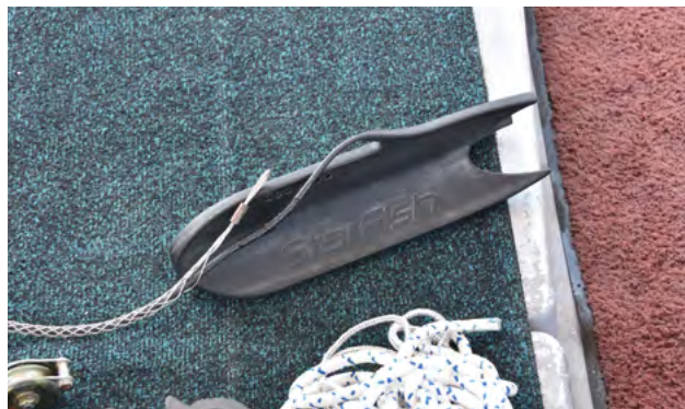
図 3-6-11 小型サイドスキャンソナーヘッド（福岡県大島周辺の調査） 外洋で用いるには適しないが、携行性に優れ、浅い水深の静水面での使用に適している。
