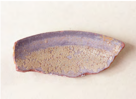
図5-3-10 釉薬が粉状化した陶磁器
