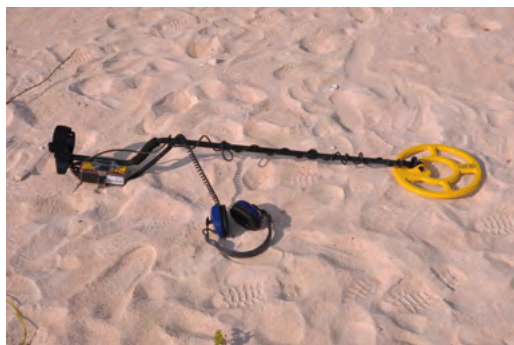
図 3-6-32 金属探知機 金属探知機は、鉄に限らず多種の金属を検知可能。
