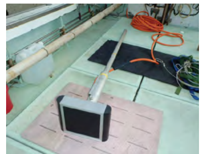
図 3-6-21 サブボトムプロファイラ送受波部（相島海底遺跡）
