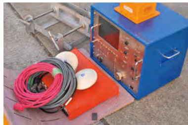
図 3-6-22 サブボトムプロファイラ船上ユニット（相島海底遺跡）
