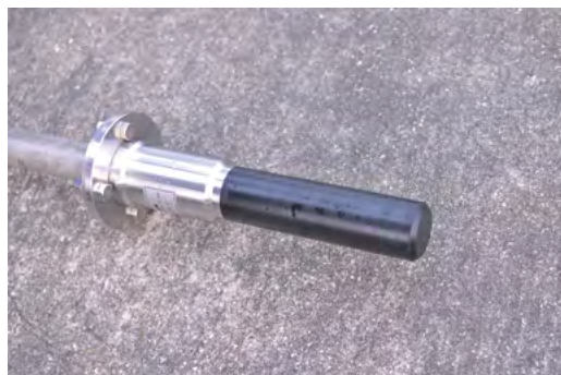
図 3-6-31 トランスポンダー（水中音響測位装置） 調査船と無人潜水機に外付けすることで、潜航中の無人潜水機の航跡を記録できる。
