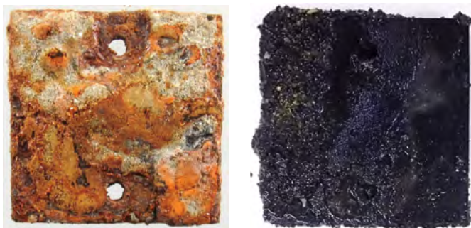
図 5-2-4 鷹島海底遺跡において異なる埋め戻し環境下に設置した鉄板試料（左：土壌のみでの埋め戻し、右：土嚢、砂質土、ガス不透過性シートによる埋め戻し）
