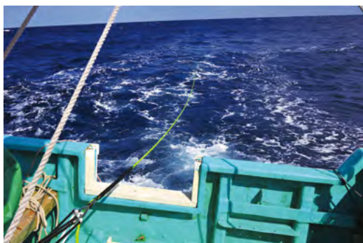
図 3-6-26 セシウム磁力計センサーの曳航 （千葉県御宿町沖の調査）
