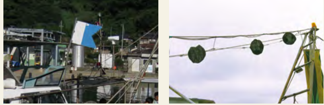
図 4-2-1 船の標識例（鷹島海底遺跡（長崎県）） 左：アルファ旗、右：三つの黒色球形掲揚物
