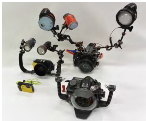
図 3-5-16 水中カメラの種類
