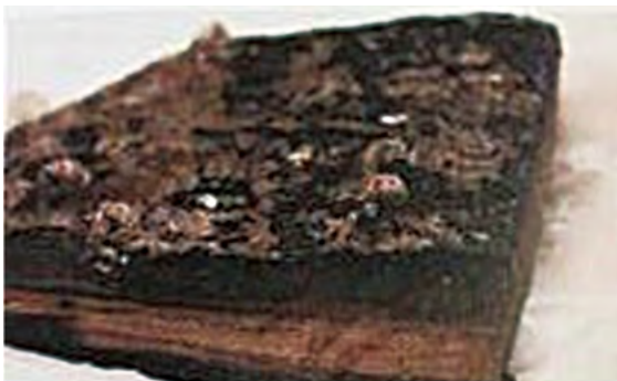
図 5-1-3 有機質遺物の生物被害 (上：フナクイムシ、下：腐朽菌) 生物劣化の要因となるフナクイムシや腐朽菌はタンニンや木材表面付着のミネラルを養分に成長する。
