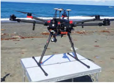
図 3-6-18 ドローン搭載型グリーンレーザースカナ (上ノ国漁港遺跡)
