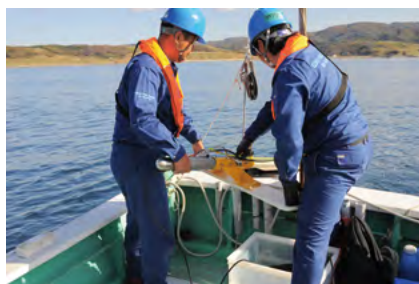
図 3-6-3 サイドスキャンソナー曳航体の投入 (上ノ国漁港遺跡)
